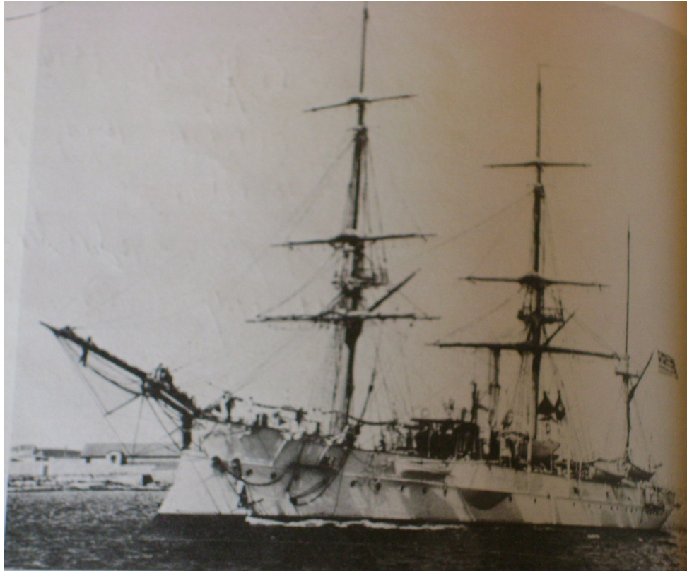
Φωτ. Νο 5:Καταδρομικό δευτέρας τάξεως «Ναύαρχος Μιαούλης». Εκτοπ. 1770 τον. Ναυπηγήθηκε το 1878-1880 στη Γαλλία. Διαστ.81/11/4,6 μέτρα. Οπλισμός: 4 ΠΒ των 17 εκ και 4 ΠΒ των 7,5 εκ. Είχε εξαρτισμό ιστιοφορίας αλλά και μηχανές που έδιναν μέγιστη ταχ. 16 κόμβους. Αθωράκιστο. (από Τα πλοία του Ελληνικού Πολεμικού Ναυτικού 1830-1979 , Κ. Παϊζη-Παραδέλη, Αθήνα 1979)
